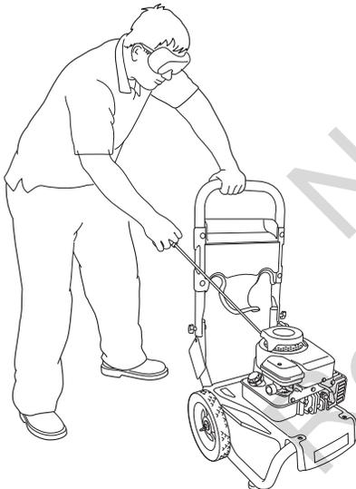
**⚠ AVERTISSEMENT** Un effet de recul (rétroaction rapide) de la corde du démarreur tirera votre main et votre bras vers le moteur plus rapidement que vous ne pouvez relâcher la corde; ce qui pourrait causer des fractures, des ecchymoses ou des entorses risquant d'entraîner des blessures graves.
