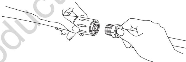
7. Choisissez la buse que vous voulez utiliser, tirez la bague de la rallonge de buse, insérez la buse, puis relâchez la bague. Vérifiez si la buse est correctement installée en tirant dessus. Consultez la section *Comment utiliser les buses*.
