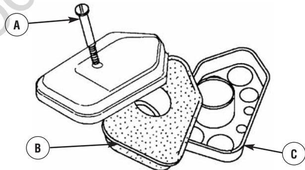
2. Enlevez l'ensemble filtre à air avec soin de manière à éviter la chute de débris dans le carburateur.
