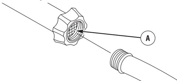
5. Connectez le tuyau d'arrosage (ne pas dépasser 50 pieds dans la longueur) à la prise d'eau. Serrez manuellement.
