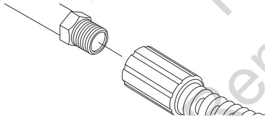
3. Faites couler de l'eau dans le tuyau d'arrosage pendant 30 secondes pour nettoyer tous les débris. Fermez le robinet d'eau.
